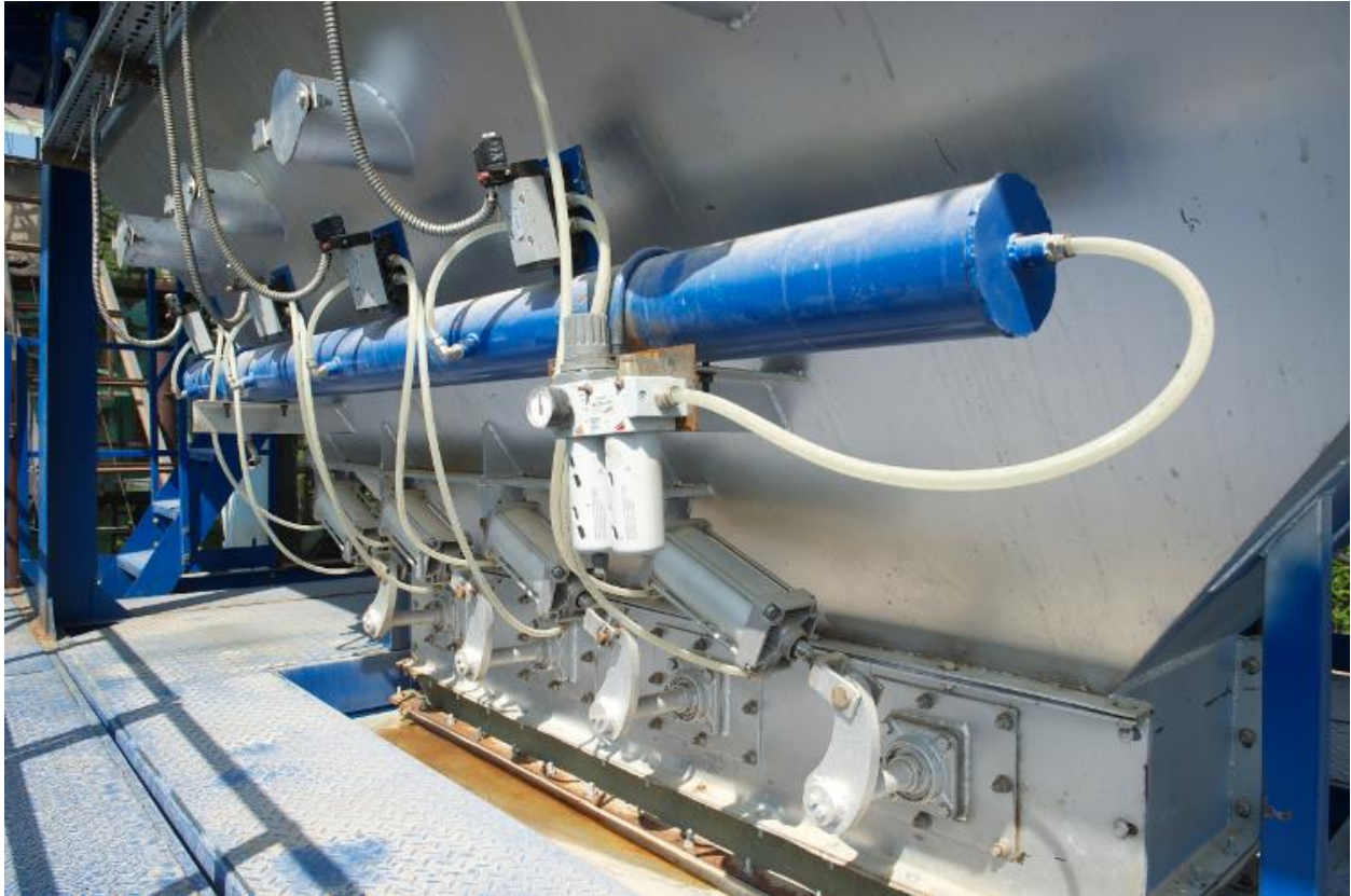
Նկար 10. Տաք ագրեգատային բունկեր (YDM -90.47.01.000)
