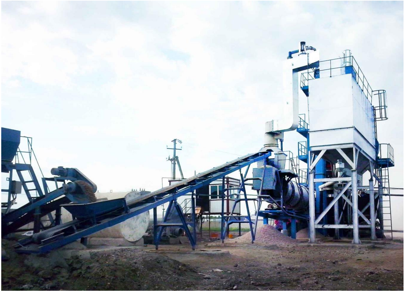
Նկար 11. Թևքային գտիչներով կահավորված ասֆալտբետոնի կայանք
